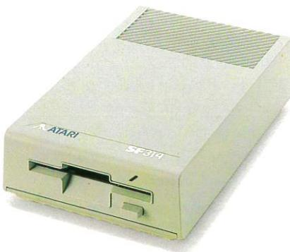
3,5 Zoll Diskettenstation mit zwei Schreib-/Leseköpfen und einer Schreibkapazität von 720 kBytes formatiert. Pro Sekunde werden 250 kBt gelesen und geschrieben. Der Anschluß erfolgt über die serielle ATARI-Schnittstelle.
